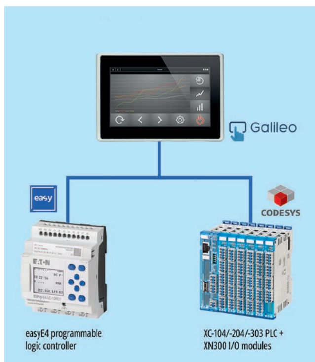
Slika 3: Upravljalni panel XV-300 kot prikazovalnik in kot prikazovalnik s funkcijo krmilnika
