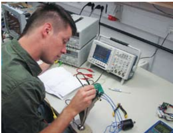
"Oživljanje" vezja za vodenje brezkrtačnega motorja
